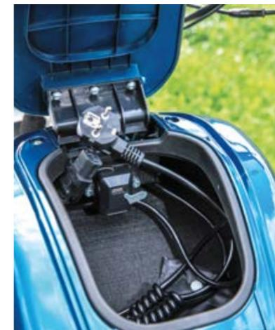
Über einen konventionellen Kaltgerätestecker wird der Akku geladen. In vier Stunden ist die leere Batterie wieder voll. Auch ein USB-Anschluss versteckt sich im Staufach.
